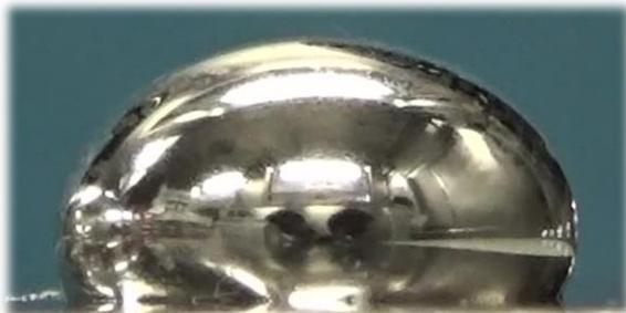
金属基板上の液体ナトリウム液滴
