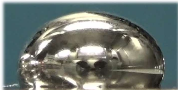
金属基板上の液体ナトリウム液滴
